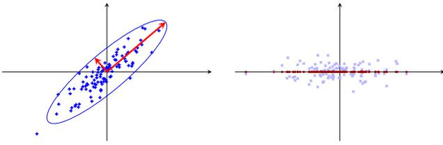
Mit Hilfe der PCA ist es möglich die Anzahl der Dimensionen so zu reduzieren, dass die Gesamtstreuung näherungsweise erhalten bleibt.
